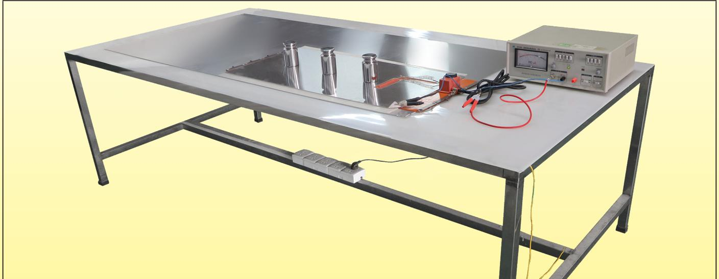
Dispositivo para medir la resistencia de aislamiento.
