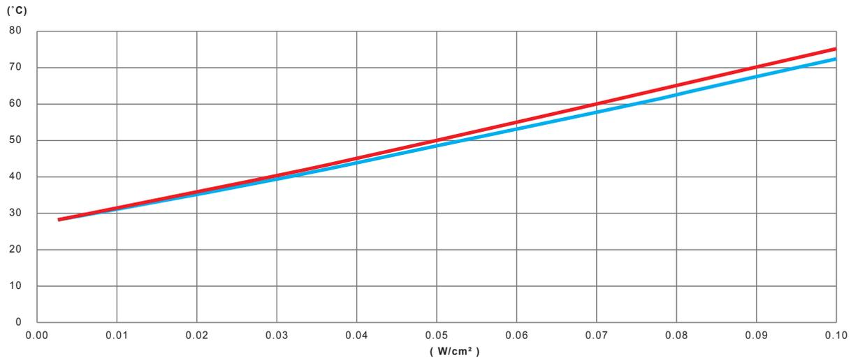
Variación, en función de la potencia en W/cm<sup>2</sup> de la cinta calefactora de silicona, de la temperatura de la pared de un tubo de PVC vacío, aislado térmicamente con 20 mm de espuma de PVC-NBR
