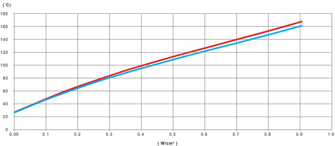
Variación, en función de la potencia en W/cm<sup>2</sup> de la cinta calefactora de silicona, de la temperatura de la pared de un tubo de acero galvanizado vacío y no aislado térmicamente
