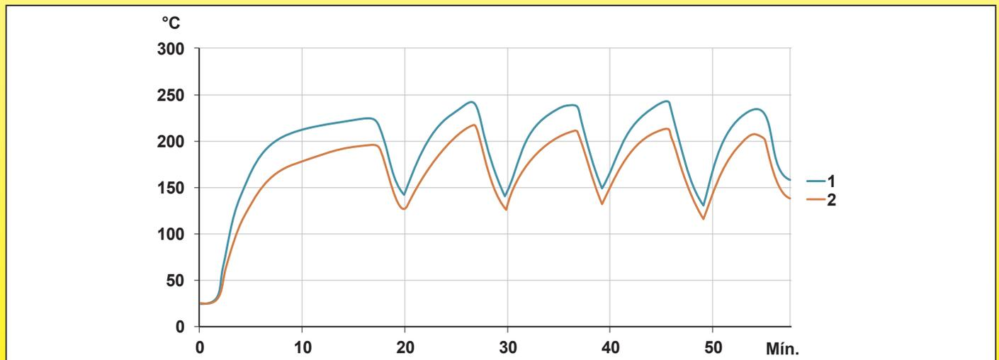
Medición de temperatura realizada en una cinta de silicona de 200 mm de ancho montada en un tambor de 55 galones (200 litros). Potencia de 2250 W (0,75 W/cm<sup>2</sup>), controlador PID con sensor ubicado en el centro del tambor vacío. Temperatura superficial limitada a 190 °C por un termostato de disco.
