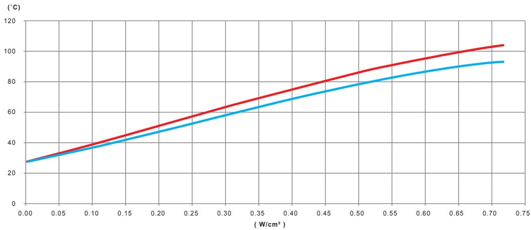
Variación, en función de la potencia en W/cm<sup>2</sup> de la cinta calefactora de silicona, de la temperatura de la pared de un tubo de acero galvanizado lleno de agua no circulante, no aislado térmicamente
