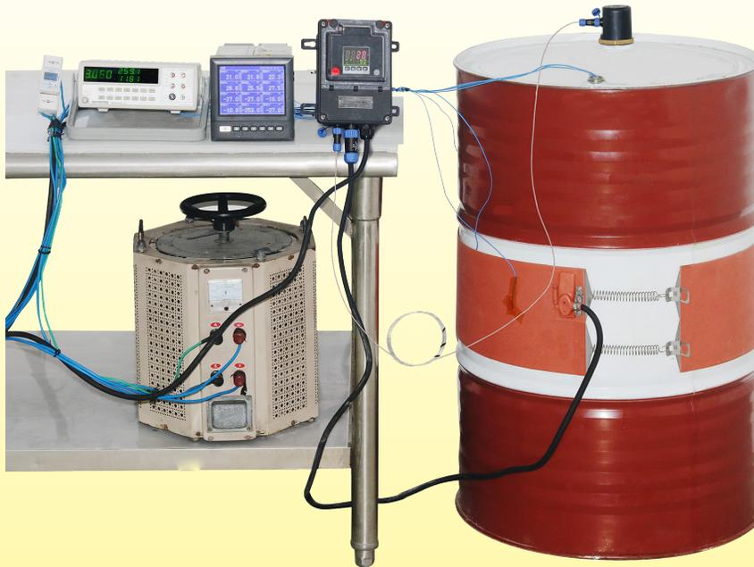
Variación de la temperatura versus el tiempo de un tambor de metal de 220 litros, **lleno de agua**, calentado por una cinta calefactora de silicona de 200 mm de ancho, sin aislamiento térmico, potencia de 2250 W (carga de potencia superficial de 0,75 W/cm<sup>2</sup>).
