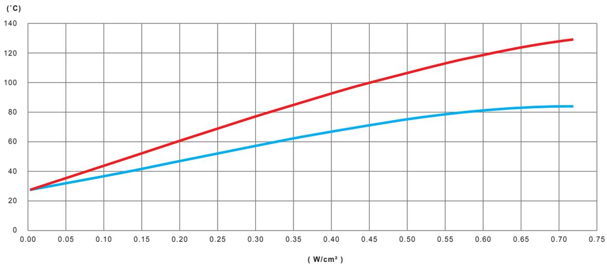
Variación, en función de la potencia en W/cm<sup>2</sup> de la cinta calefactora de silicona, de la temperatura de la pared de un tubo de PVC lleno de agua no circulante, no aislado térmicamente
