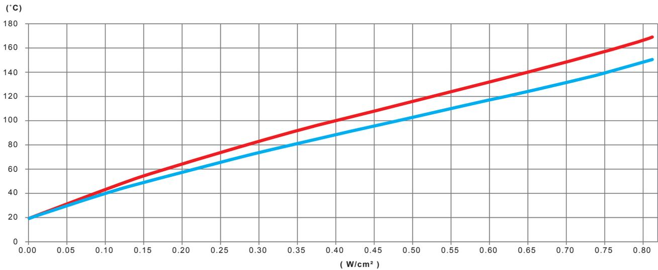
Variación, en función de la potencia en W/cm<sup>2</sup> de la cinta calefactora de silicona, de la temperatura de la pared de un tubo de acero inoxidable vacío y no aislado térmicamente
