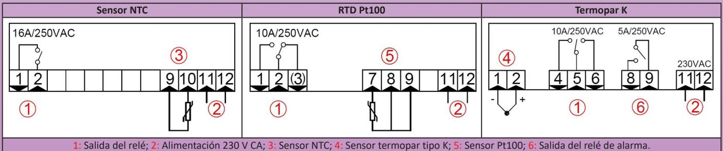
1: Salida del relé; 2: Alimentación 230 V CA; 3: Sensor NTC; 4: Sensor termopar tipo K; 5: Sensor Pt100; 6: Salida del relé de alarma.
