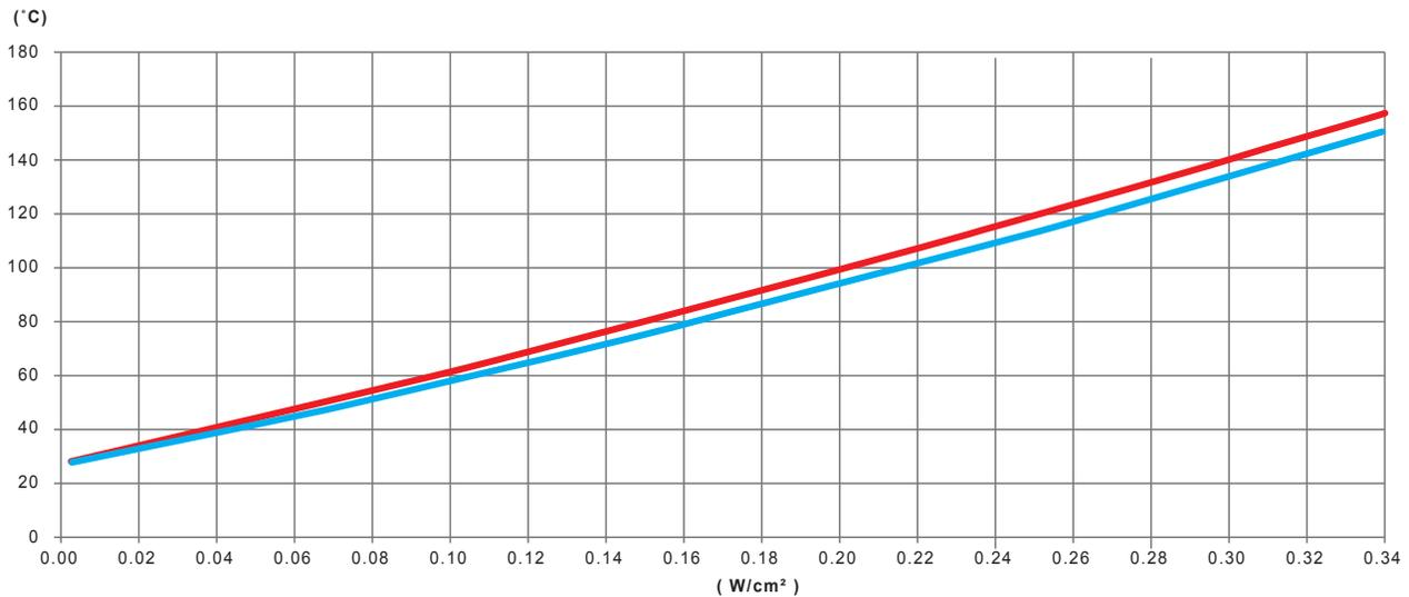
Variación, en función de la potencia en W/cm<sup>2</sup> de la cinta calefactora de silicona, de la temperatura de la pared de un tubo de acero inoxidable vacío, aislado térmicamente con 20 mm de espuma de PVC-NBR
