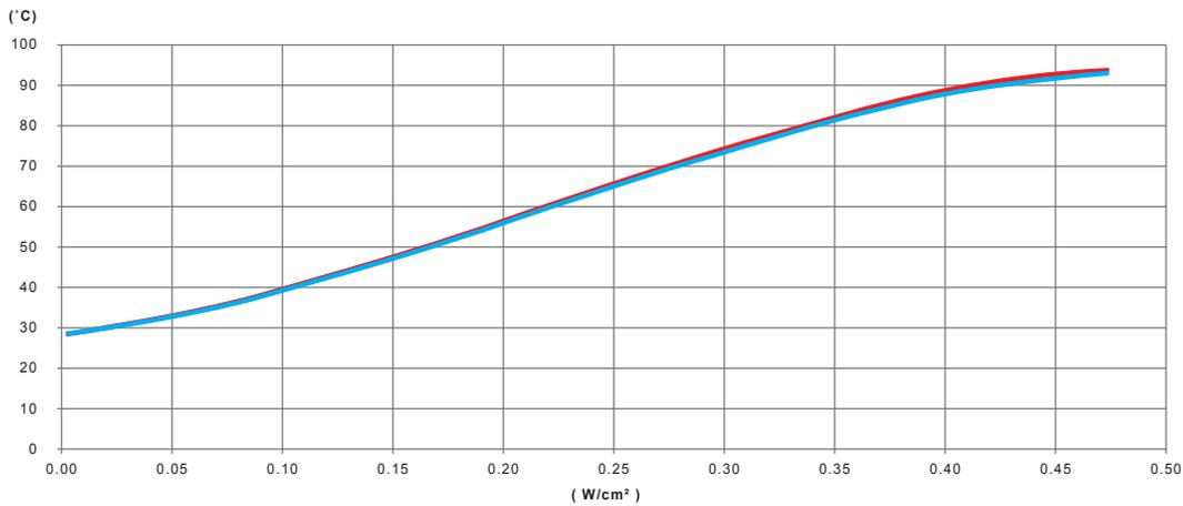
Variación, en función de la potencia en W/cm<sup>2</sup> de la cinta calefactora de silicona, de la temperatura de la pared de un tubo de acero galvanizado lleno de agua no circulante, aislado térmicamente con 20 mm de espuma de PVC-NBR
