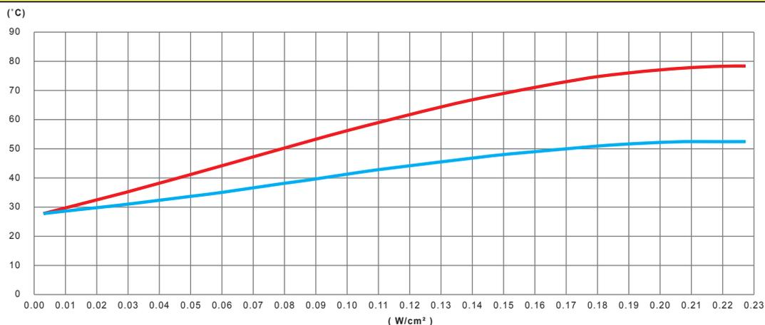
Variación, en función de la potencia en W/cm<sup>2</sup> de la cinta calefactora de silicona, de la temperatura de la pared de un tubo de PVC vacío y no aislado térmicamente.
