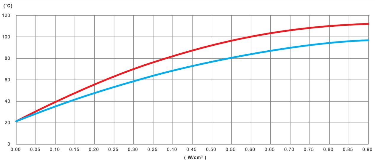
Variación, en función de la potencia en W/cm<sup>2</sup> de la cinta calefactora de silicona, de la temperatura de la pared de un tubo de acero inoxidable lleno de agua no aislado térmicamente
